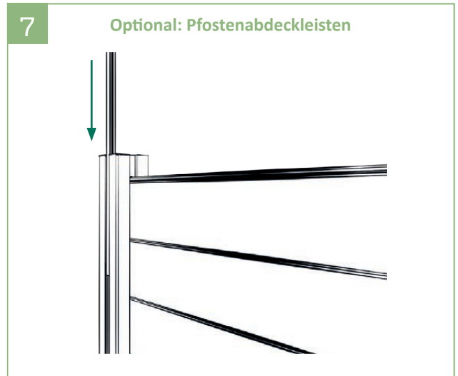
7 | Die Pfostenabdeckleisten von oben in die Pfostennut einschieben und mit der Unterkante des Pfostens bündig abschließen.
